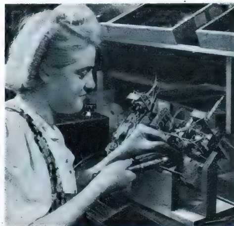
Schweißen statt Löten im Empfängerbau: Statt 900 g Lot werden bei 10 Geräten Siemens-Super nur noch 600 g gebraucht. Werkbild (Siemens)
