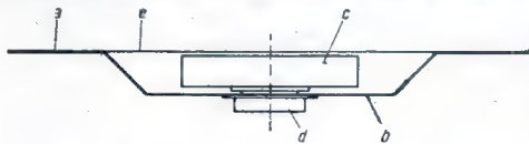
Bild 2. Einbau des neuen Peilrahmens in das Flugzeugdeck.
